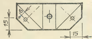
ПОСЛЕДОВАТЕЛЬНОСТЬ ГИБКИ СКОБЫ
